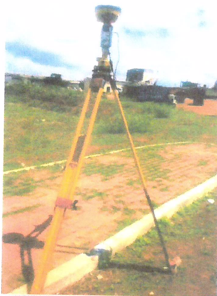
FIGURA 07: Posicionamento do GPS Geodésico sob o piquete VRT 1. FONTE: Veritas Engenharia Ambiental
